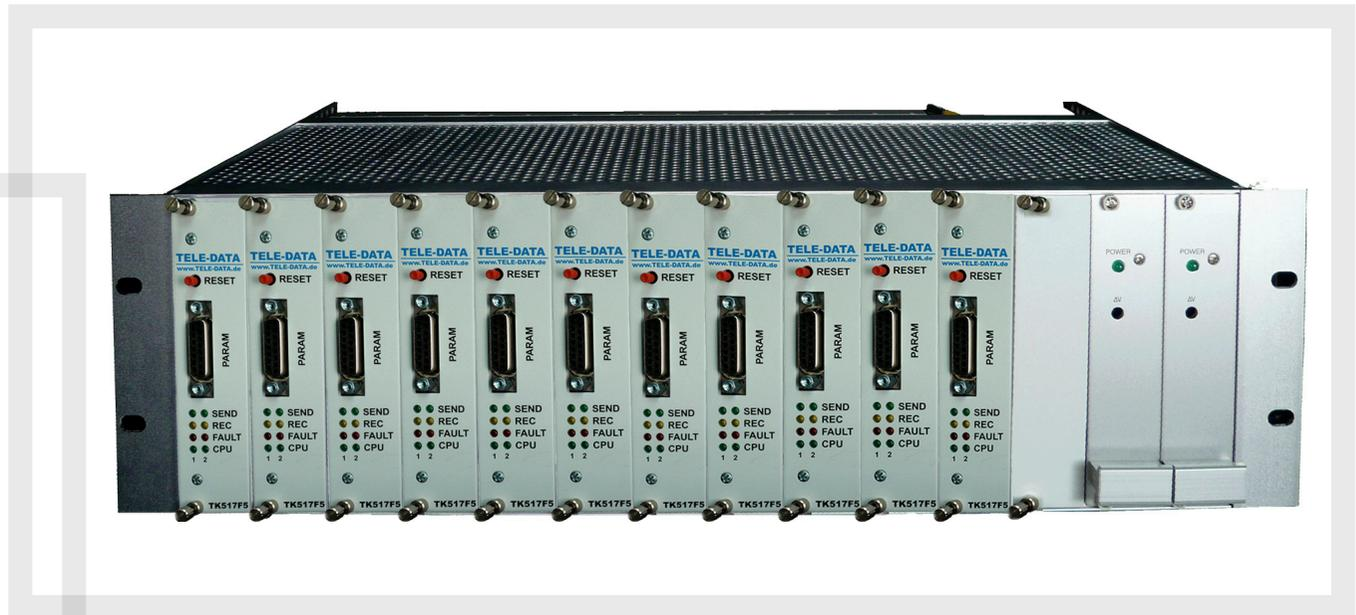
TK 517 Rack mit 12 Konvertern und 2 redundanten Stromversorgungen
