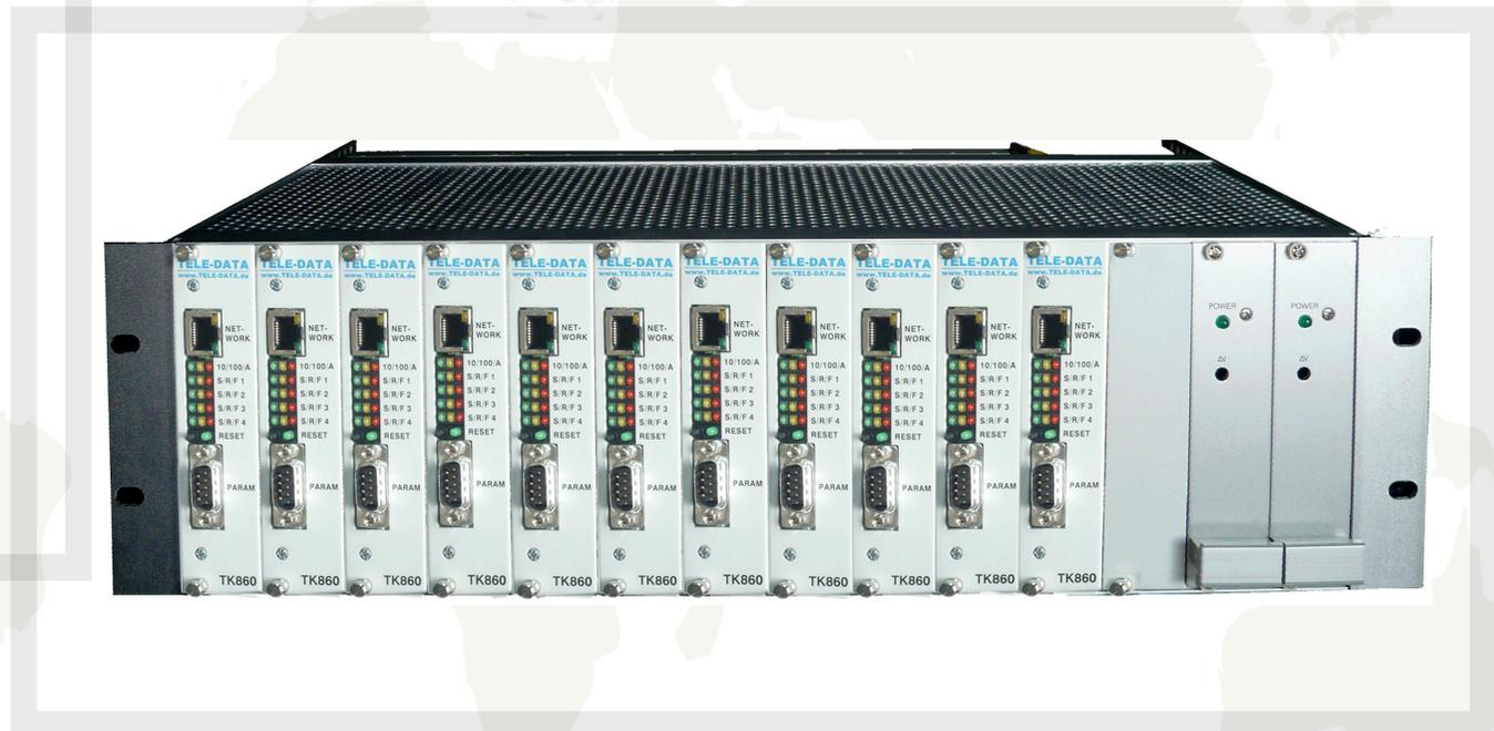
TK 860 Rack mit 12 Konvertern und 2 redundanten Stromversorgungen
